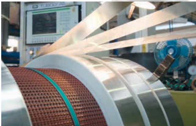
Devanadoras modernas con control electrónico.
